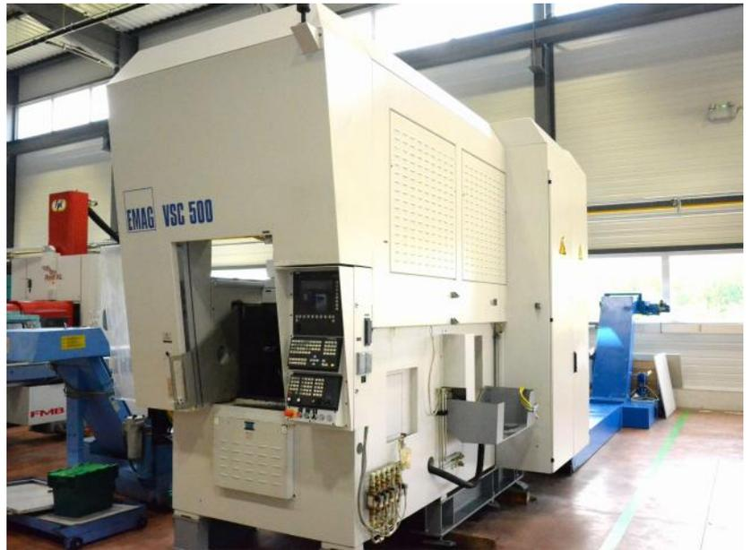
2 Ständer CNC vertikalen Drehautomat mit Achse C, angetriebene Werkzeuge, Revolverkopf und Stück Palettisierung.
