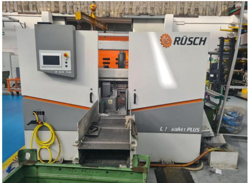
Automatische Säge mit Doppelsäule für Stangenabschnitte oder Stangenbündel
