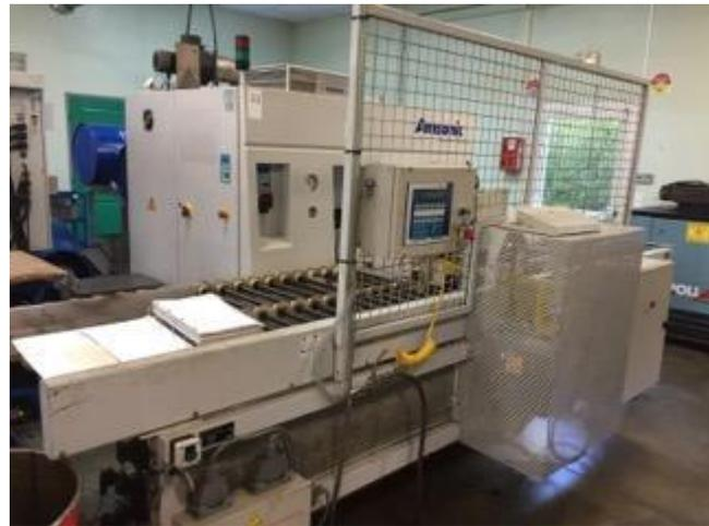
Automatische Entfettungsmaschine für Abwaschen und Trocknen.
