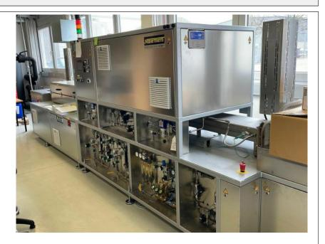
Ofen zur Wärmebehandlung von Präzisionsteilen in einer Atmosphäre auf Wasserstoffbasis
