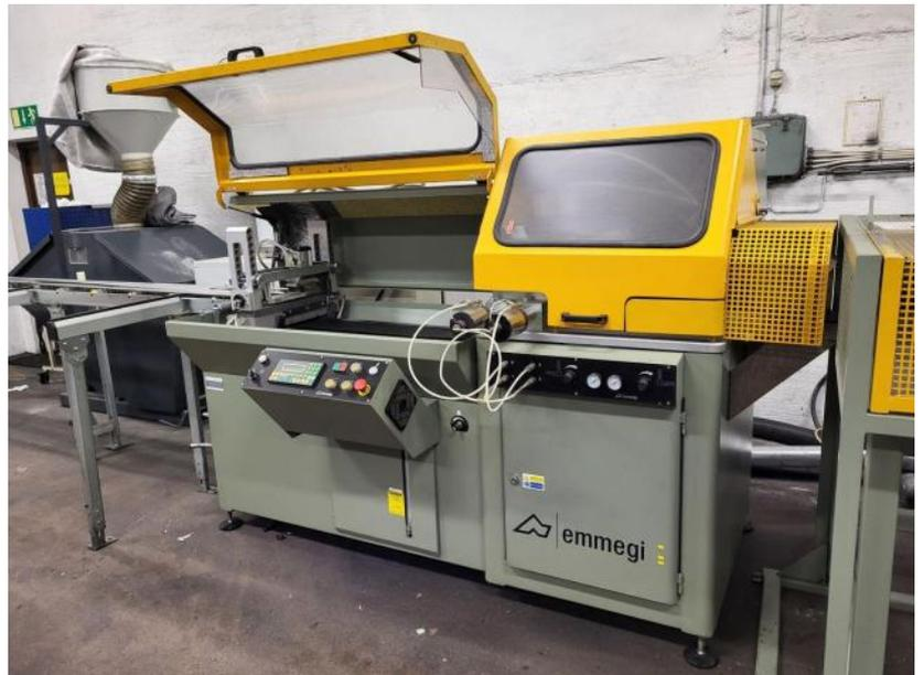
Einkopfsäge mit von unten kommendem Sägeblatt, automatischer Zyklus fürs 90°-Schneiden
