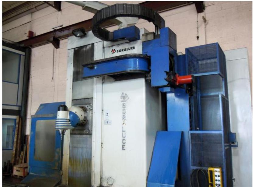
Fräsmaschine mit festem Tisch und mobiler Stütze, automatischen Kopf und Werkzeug Wechsler.
