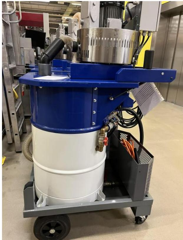
Vielseitiger Industriesauger zum Entleeren von Werkzeugmaschinen-tanks und für tägliche Wartungsarbeiten.
